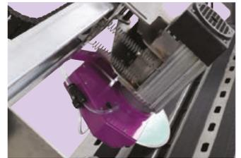
Fijación de la potencia de aluminio ajustado por **tornillos avellanados**
