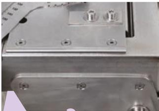
Fácil de limpiar la máquina y el tanque gracias a la **bandejas con apertura de mariposa**
