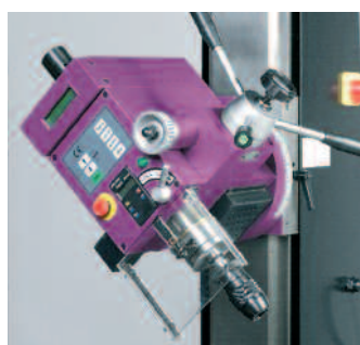
Tête de fraisage pivotante
