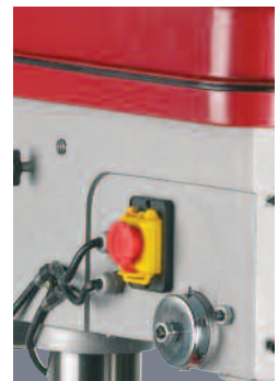
Interrupteur marche/arrêt avec arrêt coup de poing à accrochage
