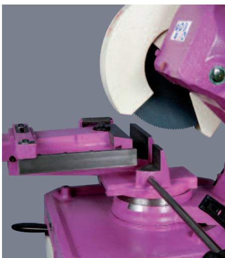
Étau à déplacement avant - arrière pour la finition de gros profilés
