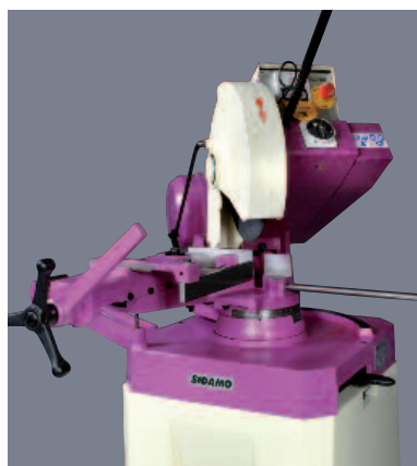
Tête et étau pivotants à 45° à gauche et à droite
